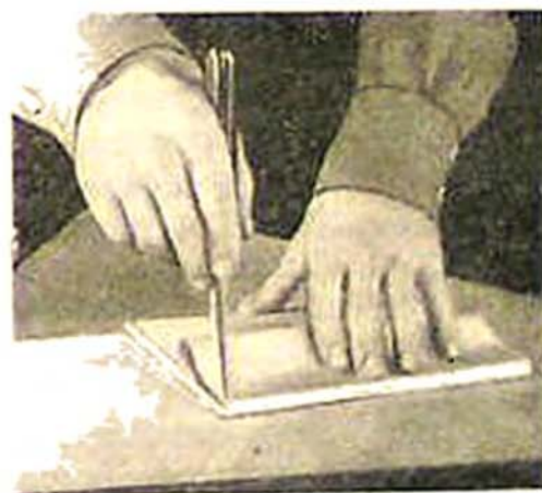
Рис. 27. Отметки для обреза по согнутому форзацу
