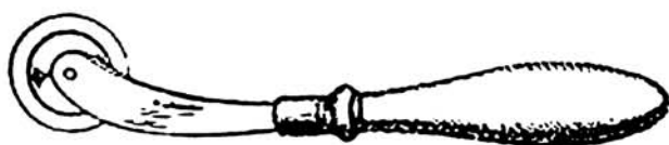
Рис. 61. Ролик для тиснения рамки
