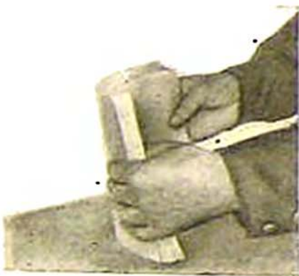
Рис. 19. Выравнивание листов сталкиванием
