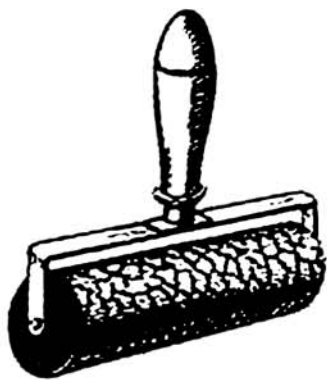
Рис. 18. Валик для нанесения рисунка на бумагу
