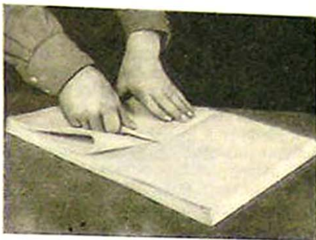
Рис. 20. Фальцовка листов в тетрадь при помощи косточки
